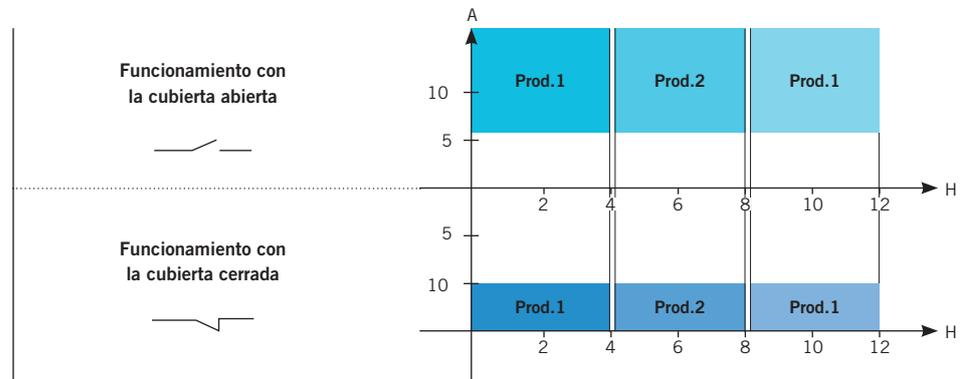
Cuando la cubierta esté cerrada sobre el vaso, la intensidad de producción del aparato se reducirá en un 50%. Un aparato ajustado a 10A no producirá más de 5A con la cubierta cerrada.
