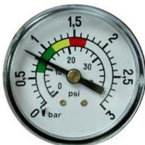
**0,8 kg/cm<sup>2</sup> – 11,4 PSI:** Presión inicial de un filtro al iniciar un ciclo de filtración
