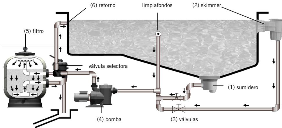
El agua se aspira del fondo de la piscina a través del sumidero (1) y de la superficie por medio de los skimmers (2), llegando a través de la bomba (4) al filtro (5) por conducciones separadas provistas de sus correspondientes válvulas (3) y retornándolo a la piscina a través de unos distribuidores (6, boquillas de impulsión). Las boquillas van instaladas en el lado opuesto del sumidero y skimmers, proporcionando de esta manera una renovación total del agua de la piscina.
